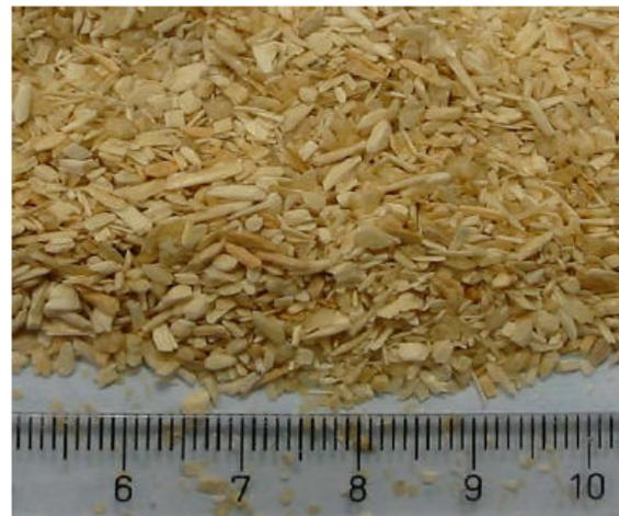
Als Richtwerte können gelten, dass Holzstoffe - mit Teilchengrößen von 0 – 4 mm - in Anteilen von 40 – 80%, Kunststoffe und Additive in Anteilen von 60 – 20% eingesetzt werden.
